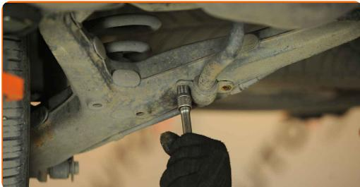
**4** Fjern stabilisatorstag forings brakettene. Bruk en flat skrutrekker.
