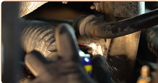
**3** Skru løs festene til stabilisatorstag forings brakettene. Bruk en pipenøkkelinnsats #13. Bruk en skrallenøkkel.
