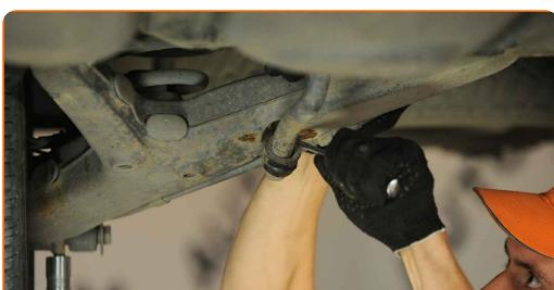
**7** Rengjør montasjeflaten til stabilisatorstag foringene. Bruk en stålborste. Bruk WD-40 spray.
