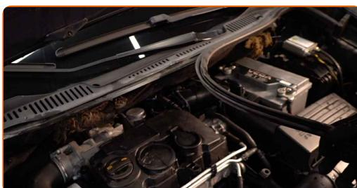
**4** Skru løs festene til brettet til torpedoplaten under vindusviskeren. Bruk Torx T30.
