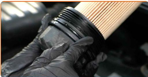
**21** Installer et nytt oljefilterhusdeksel og stram det. Bruk en 76-14F-pipenøkkelinnsats. Bruk en momentnøkkel. Stram den til 24 Nm dreiemoment.
