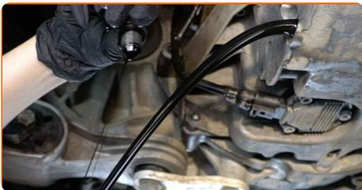
**Utskifting: motorolje og oljefilter – SEAT Cordoba I Vario Varebil / Stasjonsvogn (6K5). Tips:**
