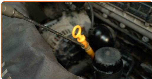
**6** Skru løs filterhushetten sammen med det gamle filterelementet. Bruk en 76-14F-pipenøkkelinnsats. Bruk en skrallenøkkel.
