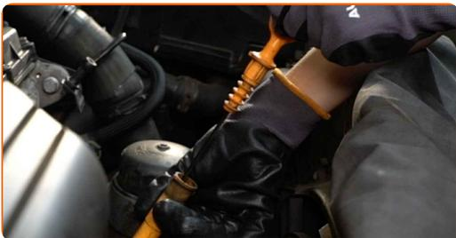
**5** Rengjør lokket til oljefilterhuset. Bruk universal rengjøringspray.
