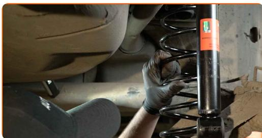
**18** Støtt opp det bakre hjulopphengets bjelke. Bruk en hydraulisk jekk.
