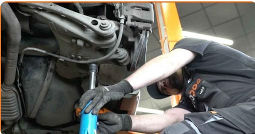
**31** Stram det nedre feste på støtdemperen. Bruk en kombinasjonsnøkkel #21. Bruk en pipenøkkelinnsats #21. Bruk en momentnøkkel. Stram den til 150 Nm dreiemoment.+90°
