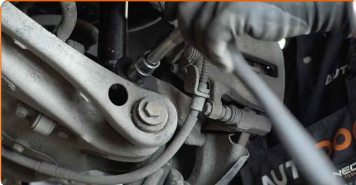
**30** Støtt armen. Bruk en hydraulisk jekk.
