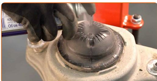
**24** Fjern mutteren på beinets stempelstang. Bruk en pipenøkkelinnsats #19. Bruk en skrallenøkkel.
