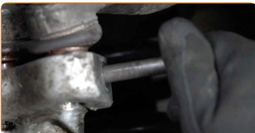
**11** Fjern den øvre bæreamen fra rattspindelen. Bruk en flat metal meisel. Bruk en hammer.
