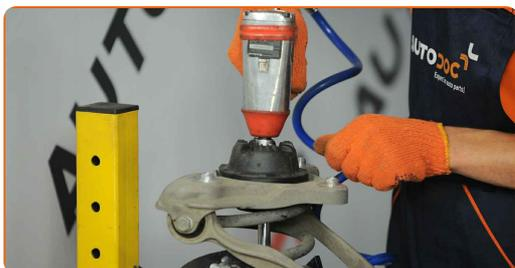
**25** Fjern det øvre festet til støtdemperen, som er montert med bæreamene.
