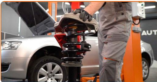
**33** Stram fjærbeinets stempelstangmutter. Bruk en pipenøkkelinnsats #19. Bruk en skrallenøkkel. Bruk en momentnøkkel. Stram den til 50 Nm dreiemoment.
