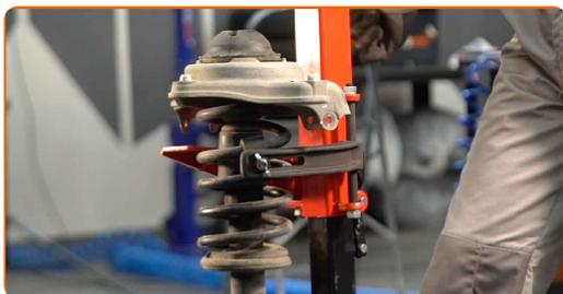
**23** Behandle stangen til fjærbeinet. Bruk en stålbørste. Bruk WD-40 spray.
