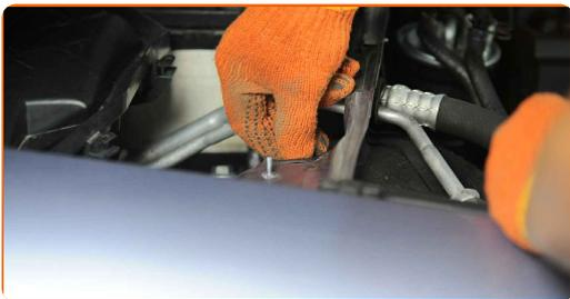
**40** Monter og fest dekselet mellom fronruten og panseret på høyre side.
