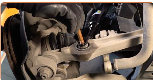
**47** Fest den øvre bæreamen til rattspindelen. Bruk en gummihammer. Bruk en flat metal meisel. Bruk en hammer.
