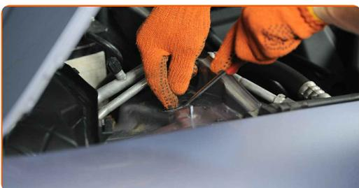
**19** Skru løs de øvre festene til fjærbeinet. Bruk en pipenøkkelinnsats #16. Bruk en skrallenøkkel.
