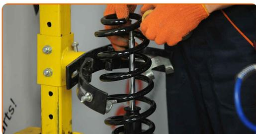
30 Installer støvbeskytteren og støtstopperen på støtdemperen.
