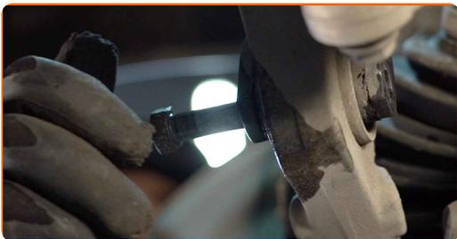
**9** Skru løs de øvre armfestene. Bruk en kombinasjonsnøkkel #16. Bruk en pipenøkkelinnsats #16. Bruk en skrallenøkkel.
