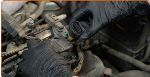
**8** Behandle pluggen til tennspolen med elektrospray. Sprayen beskytter den elektriske kontakten mot korrosjon og oksidasjon, samt reduserer kontaktmotstand.
