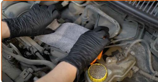
**6** Fjern også tennspolen fra hullet til tennpluggen iylinderhodet. Bruk et brekkjern.
