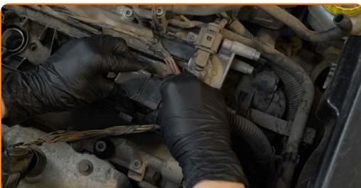
**10** Monter tennspolene til hullene til tennpluggene. Pass på at du hører et klikk som indikerer at den er låst på plass.
