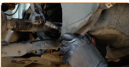
8 Skru løs festene som kobler stabilisator-ledd til fjærbein. Bruk en pipenøkkelinnsats #16. Bruk en skrallenøkkel.
