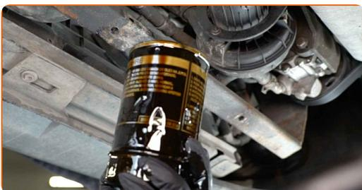
**13** Rengjør setet til oljefilteret. Bruk universal rengjøringspray.
