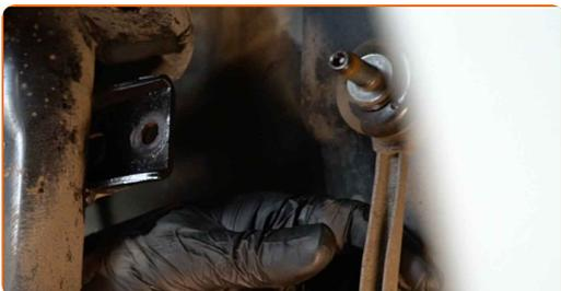
**16** Koble ledningene og bremseslangen fra braketten på fjærbeinet. Bruk et brekkjern.
