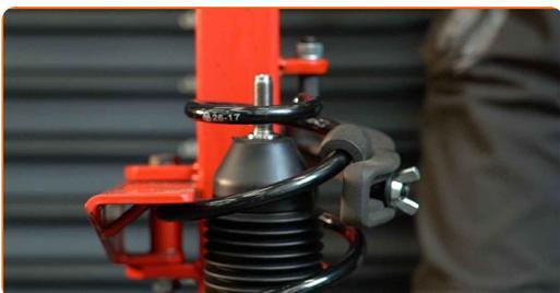
**42** Installer den øvre demperen og monteringslager.
