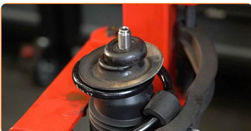
**43** Stram fjærbeinets stempelstangmutter. Bruk en pipenøkkelinnsats #21. Bruk HEX nr. H6. Bruk en momentnøkkel. Stram den til 60 Nm dreiemoment.
