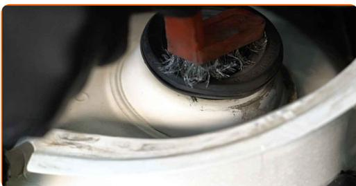
**7** Løsne det øverste festet på fjærbeinets montering. Bruk en kombinasjonsnøkkel #21. Bruk HEX nr. H6. Bruk en skrallenøkkel.
