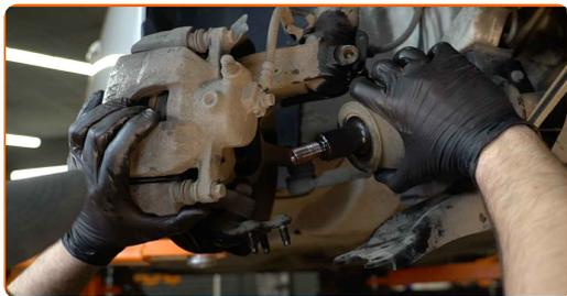
**25** Løft opp styrespindelen. Bruk en hydraulisk jekk.
