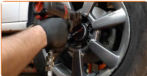
**69** Senk bilen og stram hjulboltene, arbeid på kryss. Bruk en kraftpipe for hjulmutter #17. Bruk en momentnøkkel. Stram den til 120 Nm dreiemoment.
