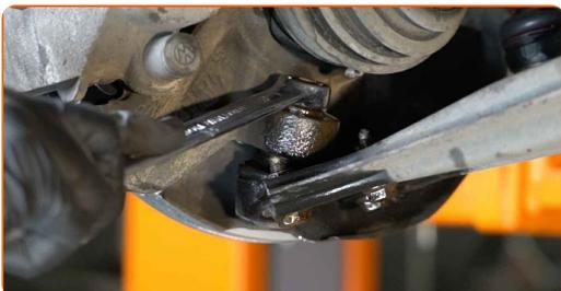
**8** Skru løs festene som binder kuleleddet til kontrollarmen. Bruk en pipenøkkelinnsats #13. Bruk et svingjern.
