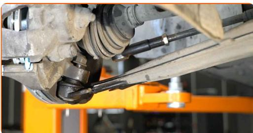
**10** Koble kuleleddet fra styrespindelen. Bruk et brekkjern. Bruk en avtrekker for kuleledd.
