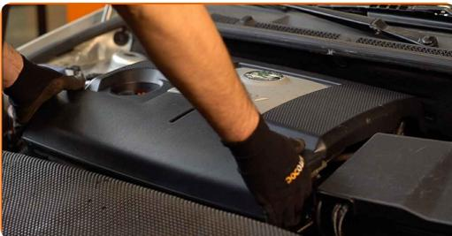
4 Dekk til gasspjeldet med en mikrofiberklut for å forhindre at støv og smuss kommer seg inn i systemet.
