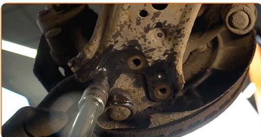
**19** Løft opp styrespindelen. Bruk en hydraulisk jekk.
