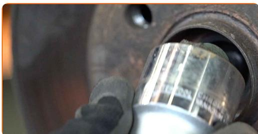
**22** Behandle montasjeflaten til drivakslingen hos rattspindelen. Bruk WD-40 spray.
