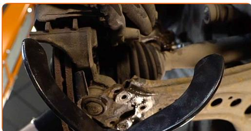
**21** Skru løs festene som binder drivaksel til hjulnavet. Bruk muttetrekker 12-kant sokkel #36.
