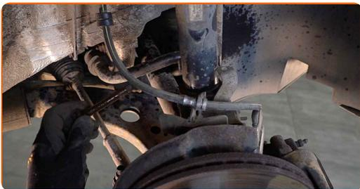
**16** Friggjør nedre feste som kobler fjærbein til styrespindel. Bruk en spesiell pipenøkkel til å fjerne støtdemperen. Bruk en skrallenøkkel.
