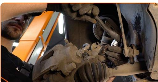
**17** Rengjør kuleleddets monteringsflate. Bruk en stålborste. Bruk WD-40 spray.
