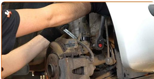
**14** Fjern bremseslangen fra fjærbeinet. Bruk et brekkjern.
