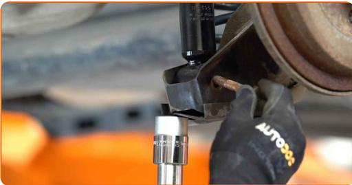
14 Stram det nedre feste på støtdemperen. Bruk en pipenøkkelinnsats #16. Bruk en kombinasjonsnøkkel #16. Bruk en momentnøkkel. Stram den til 40 Nm dreiemoment.+90°
