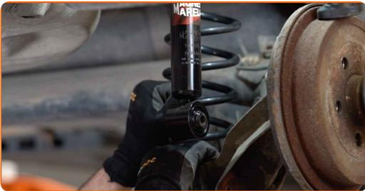
13 Sikre den bakre akselbjelken. Bruk en hydraulisk jekk.
