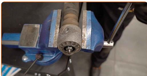
**15** Fjern støtdemperen stempelstangen feste. Bruk en kombinasjonsnøkkel #17. Bruke en justerbar skiftenøkkel.
