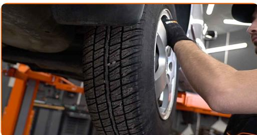
**6** Skru løs og fjern festene på dekselet til hjulbuen. Bruk Torx T25.
