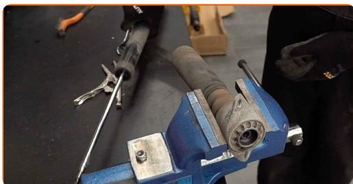
**17** Fjern støtdemperfestet, støvbeskytteren og støtstopperen.
