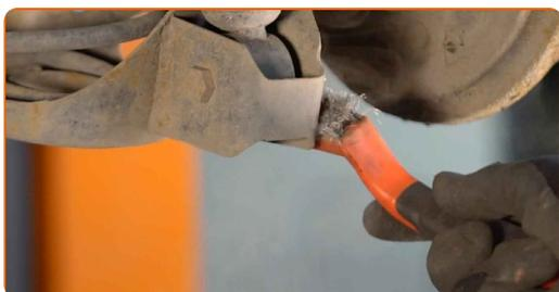
**7** Skru fast det nedre festet på støtdemperen. Bruk en kombinasjonsnøkkel #16. Bruk en pipenøkkelinnsats #16. Bruk en skrallenøkkel.
