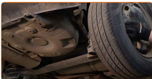
**6** Rengjør festene til støtdemperen. Bruk en stålborste. Bruk WD-40 spray.
