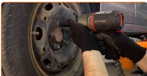
22 Senk bilen og stram hjulboltene, arbeid på kryss. Bruk en kraftpipe for hjulmutter #17. Bruk en momentnøkkel. Stram den til 120 Nm dreiemoment.
