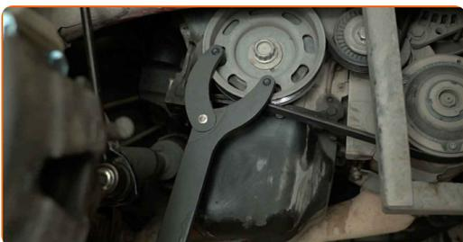
**99** Stram festet til reimskiven til veivakselen. Bruk 12-kant-pipe nummer 21. Bruk en momentnøkkel. Stram den til 90 Nm dreiemoment.+90°
