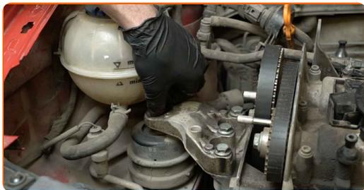
**34** Rengjør motorens monteringsfester. Bruk en stålbørste. Bruk WD-40 spray.
