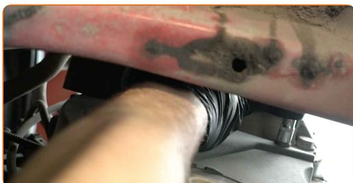
**25** Åpne klipsene til det nedre registerdekselet. Bruk et brekkjern.
