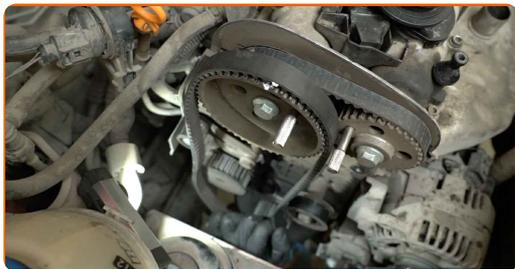
**44** Rengjør festene til løpehjulet til registerreimen. Bruk en stålbørste. Bruk WD-40 spray.
