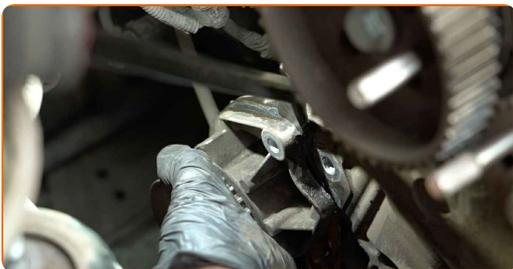
**54** Skru løs festene til vannpumpen. Bruk HEX nr. H6. Bruk en skrallenøkkel.
