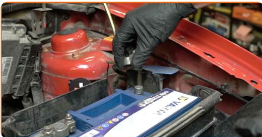
6 Løs slangen til ventilen for veivhusventilasjon fra motordekselet på høyre side.
