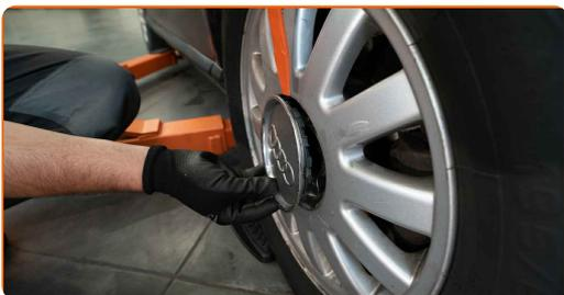
**5** Skru løs navets låsemutter. Bruk 1-3/16" muttertrekker 12-kant sokkel.
