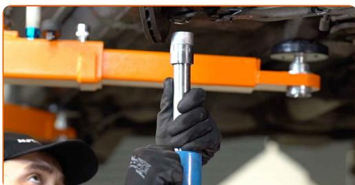
**19** Frigjør nedre feste som kobler fjærbein til styrespindel. Bruk en spesiell pipenøkkel til å fjerne støtdemperen.
