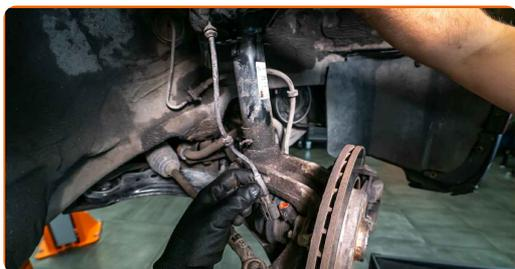
**11** Skru løs festene som binder drivaksel til hjulnavet. Bruk 1-3/16" muttertrekker 12-kant sokkel.
