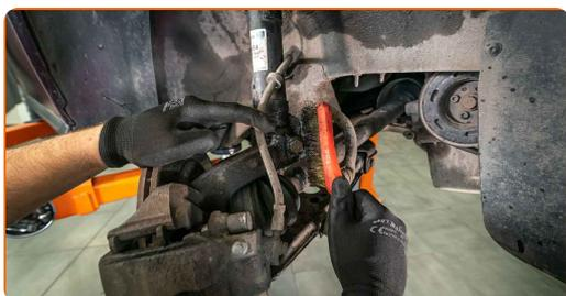
**13** Skru løs festene som binder kuleleddet til kontrollarmen. Bruk en pipenøkkelinnsats #13.
