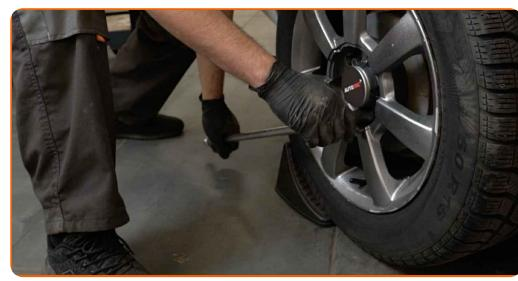
Løsne hjulfesteboltene. Bruk en kraftpipe for hjulmutter #17.
