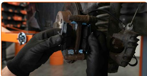
Utskifting: bremseklosser – SKODA Octavia I Varebil / Stasjonsvogn (1U5).
