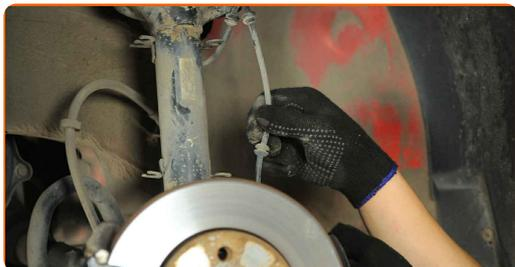
**10** Rengjør festene som kobler fjærbein til styrespindel. Bruk en stålbørste. Bruk WD-40 spray.
