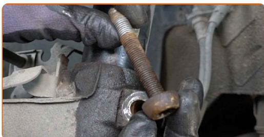
**26** Frigjør nedre feste som kobler fjærbein til styrespindel. Bruk en spesiell pipenøkkel til å fjerne støtdemperen.
