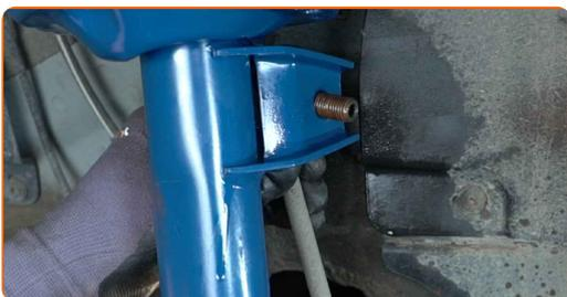
**59** Skru inn festene som forbinder stabilisatorstaget med fjærbeinet. Bruk en kombinasjonsnøkkel #18. Bruk XZN #6. Bruk en skrallenøkkel.
