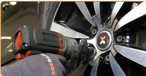
**72** Senk bilen og stram hjulboltene, arbeid på kryss. Bruk en kraftpipe for hjulmutter #17. Bruk en momentnøkkel. Stram den til 120 Nm dreiemoment.
