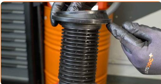
**41** Monter den øvre holderen til fjærbeinet sammen med støtstopperen.
