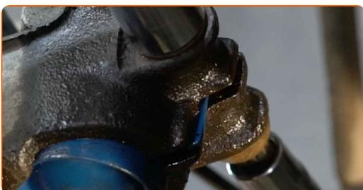
**56** Installer og stram drivaksel boltene. Bruk 12-kant-pipe nummer 24. Bruk en skrallenøkkel.
