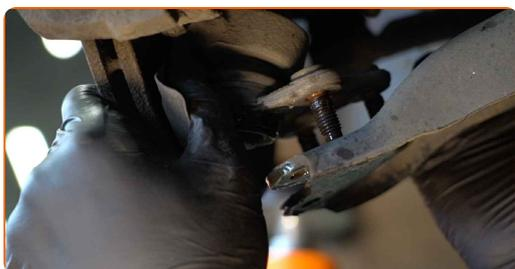
**23** Skru løs festene som binder drivaksel til hjulnavet. Bruk en pipenøkkelinnsats #36.
