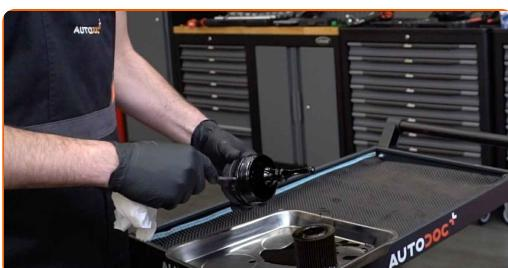
**19** Rengjør lokket til oljefilterhuset. Bruk universal rengjøringsspray.
