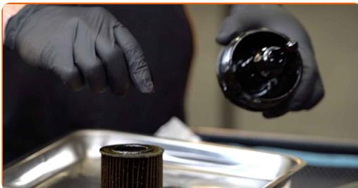
**18** Fjern O-ringen til oljefilterdekslet. Bruk en flat skrutrekker.
