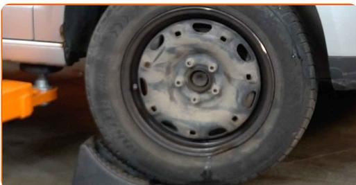
**2** Løsne hjulfesteboltene. Bruk en kraftpipe for hjulmutter #17.
