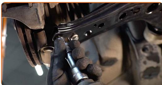
**18** Støtt armen. Bruk en hydraulisk jekk.
