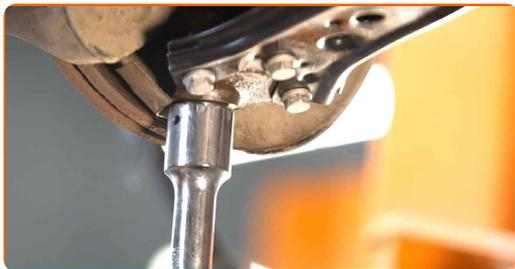
**19** Stram festene som kobler kontrollarmen til underrammen. Bruk en pipenøkkelinnsats #18. Bruk en momentnøkkel. Stram den til 70 Nm dreiemoment.+90°
