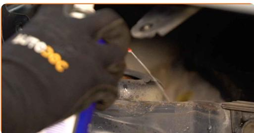
**19** Løsne det øverste festet på fjærbeinets montering. Bruk en pipenøkkelinnsats #20.6. Bruk en skrallenøkkel.
