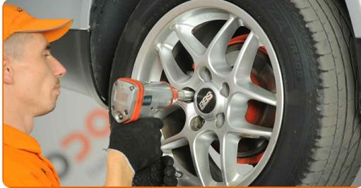
**31** Senk bilen og stram hjulboltene, arbeid på kryss. Bruk en momentnøkkel. Stram den til 120 Nm dreiemoment.
