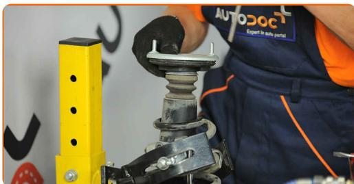
**23** Stram fjærbeinets stempelstangmutter. Bruk HEX nr. H5. Bruk en pipenøkkelinnsats #19. Bruk en momentnøkkel. Stram den til 50 Nm dreiemoment.
