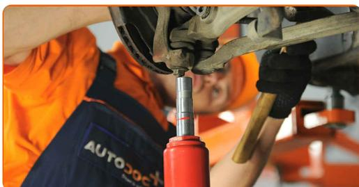
**37** Stram festebolten som forbinder gaffelen til støtdemperen med den nedre bæreamen. Bruk en kombinasjonsnøkkel #18. Bruk en pipenøkkelinnsats #18. Bruk en momentnøkkel. Stram den til 90 Nm dreiemoment.
