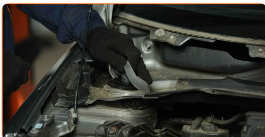
**24** Rengjør festene på fjærbeinets øvre sete. Bruk en stålbørste. Bruk WD-40 spray.
