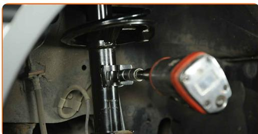
**58** Behandle festene til fjærbeinet. Behandle alle leddene på stabilisatorleddet. Bruk kobberfett.
