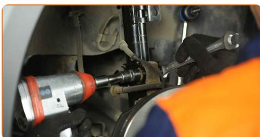
**53** Monter braketten på støtdemperens fjærbein.
