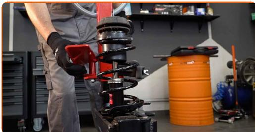
**37** Stram fjærbeinets stempelstangmutter. Bruk en kombinasjonsnøkkel #19. Bruk HEX nr. H6. Bruk en momentnøkkel. Stram den til 50 Nm dreiemoment.
