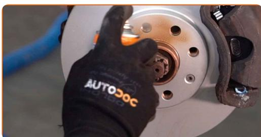
**60** Rengjør overflaten av bremseskiven. Bruk bremsrens.
