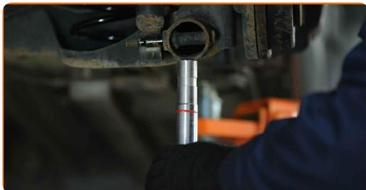
**9** Løsne løs nedre del av støtdemperen.
