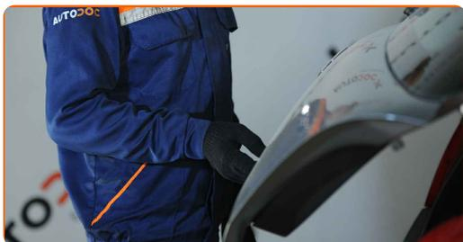
**13** Fjern klipsene til bagasjeromkledningen på siden. Bruk et demonteringsverktøy for klemmer.
