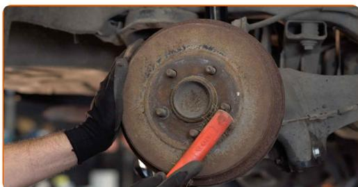
**38** Behandle overflaten hvor hjulfelgen kommer i kontakt med bremsetrommelen med et egnet middel. Bruk kobberfett.
