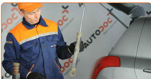
**Utskifting: støtdemper – Suzuki Swift MK3. Tips fra AUTODOCs eksperter:**
