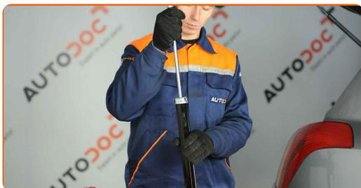
**22** Monter toppmonteringen på den nye støtdemperen og sikre den.
