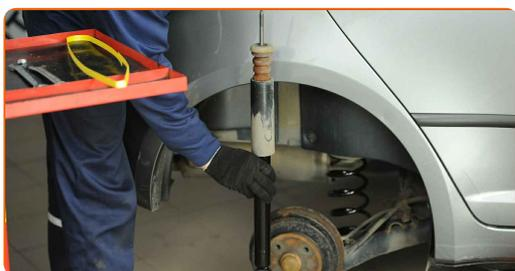
**23** Rengjør monteringsfestet til støtdemperen. Bruk en stålbørste. Bruk WD-40 spray.
