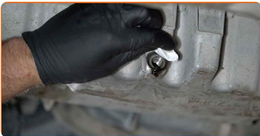
**20** Skru inn den nye dreneringspluggen og stram den. Bruk en pipenøkkelinnsats #19. Bruk en momentnøkkel. Stram den til 30 Nm dreiemoment.
