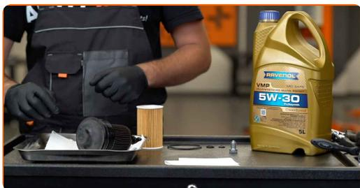
**10** Dekk til oljefilterhuset med en ren klut for å forhindre at smuss og fremmedobjekter trenger seg inn i systemet.
