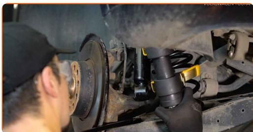
**23** Innsett den sylinderrformede delen av det nedre festet i triangelarmens nedre hull.
