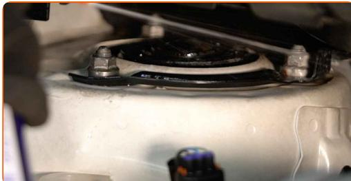
**4** Løsne det øverste festet på fjærbeinets montering. Bruk en kombinasjonsnøkkel #14.
