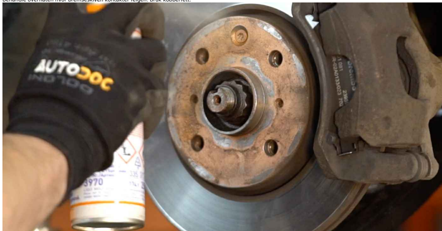
23 Rens festepunktet til felgen. Bruk bremserens.
