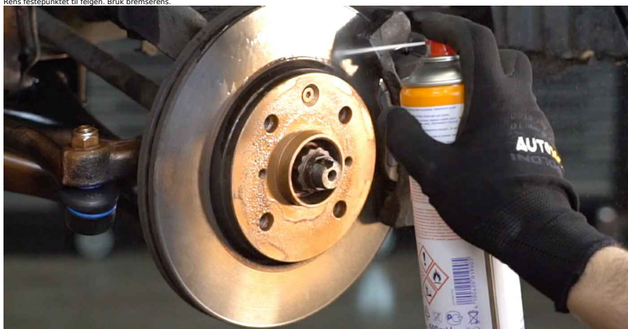
23 Rens festepunktet til felgen. Bruk bremserens.
