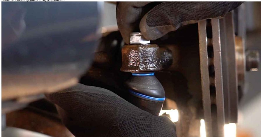
18 Stram festemutteren som kobler endeledet til rattspindelen. Bruk en pipenøkkelinnsats #17. Bruk en momentnøkkel. Stram den til 33 Nm dreiemoment.
