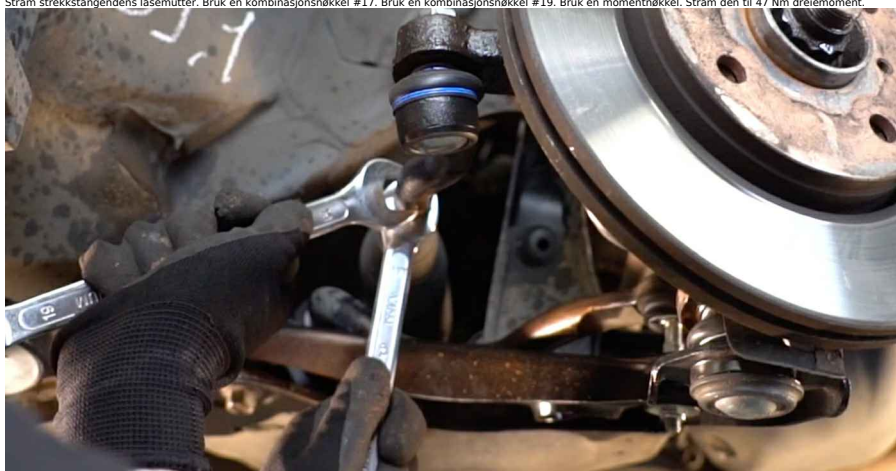
20 Installer låsesplinten som fester strekkstangens montering. club.autodoc.co.no 7-11
