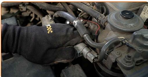
**4** Løsne på låseklemmene til drivstoffilter rørene. Bruk en rundtang.
