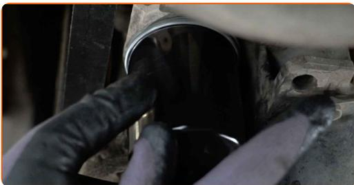
**16** Stram oljefilteret. Husk å stramme med korrekt dreiemoment. Bruk en 65-14F-pipenøkkelinnsats. Bruk en momentnøkkel. Stram den til 24 Nm dreiemoment.
