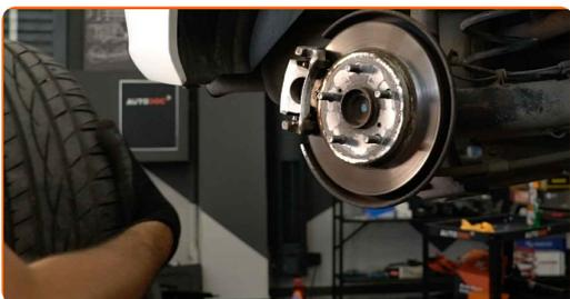
**7** Rengjør festene til bremsecaliperen. Bruk en stålbørste. Bruk WD-40 spray.
