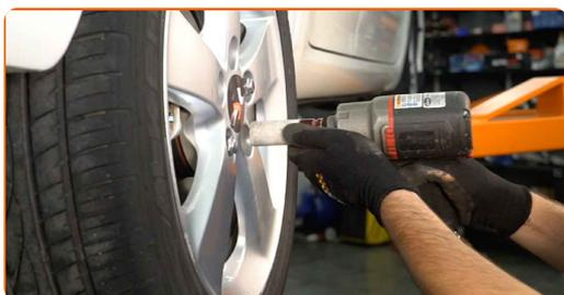
**24** Senk bilen og stram hjulboltene, arbeid på kryss. Bruk en momentnøkkel. Stram den til 103 Nm dreiemoment.
