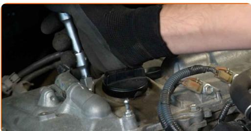
**13** Skru på nye tennplugger og stram dem. Bruk tennpluggpipe #16. Bruk en momentnøkkel. Stram den til 20 Nm dreiemoment.
