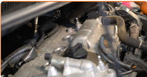
**11** Påfør et tynt lag med et spesielt høytemperaturfett på gjengene til de nye tennpluggene.
