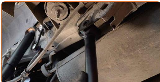
Utskifting: nedre langsgående bærearmer i opphenget bak – TOYOTA Land Cruiser Prado 150 (J150). Tips fra AUTODOCs eksperter:
