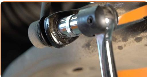
**8** Skru løs festene som kobler stabilisator-ledd til fjærbein. Bruk en pipenøkkelinnsats #17. Bruk et svingjern.
