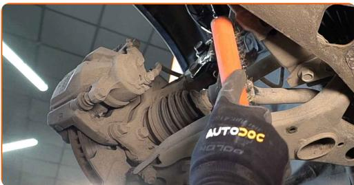
**7** Skru løs festene som kobler stabilisator-ledd til stabilisatorstag. Bruk en pipenøkkelinnsats #17. Bruk et svingjern.
