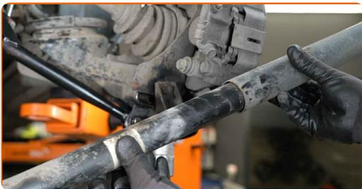
**18** Rengjør monteringsfestet til støtdemperen. Bruk en stålbørste. Bruk WD-40 spray.
