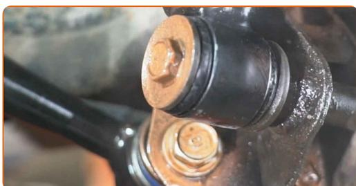
**24** Monter delene til det øvre festeelementet til støtdemperen.
