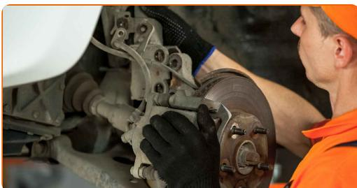
**42** Fest fjærbeinet på styrespindelen. Bruk et brekkjern.
