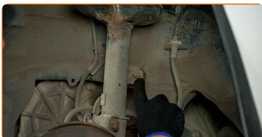
7 Skru løs festene som kobler stabilisator-ledd til fjærbein. Bruk en pipenøkkelinnsats #14. Bruk en skrallenøkkel.
