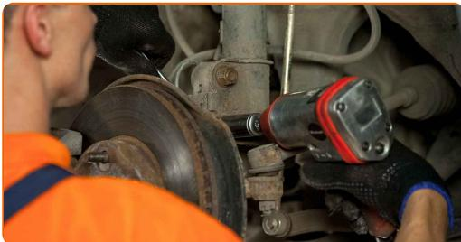
**45** Fest bremseslangen på beinet. Koble ABS-sensorkabelens lås til fjærbeinet. Bruk en pipenøkkelinnsats #12. Bruk en skrallenøkkel.
