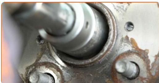
**18** Rengjør festet som kobler kuleledd til styrespindel. Bruk en stålbørste. Bruk WD-40 spray.
