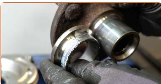
**41** Press ut lageret til hjulnavet. Bruk et avtrekkersett for hylser og lager.
