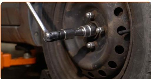
4 Løsne hjulfesteboltene. Bruk en kraftpipe for hjulmutter #21.
