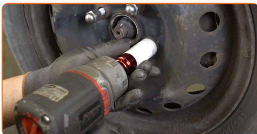
**80** Senk bilen og stram hjulboltene, arbeid på kryss. Bruk en kraftpipe for hjulmutter #21. Bruk en momentnøkkel. Stram den til 103 Nm dreiemoment.
