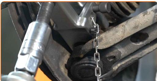
**23** Rengjør festene på braketten til bremsecaliperen. Bruk en stålbørste. Bruk WD-40 spray.
