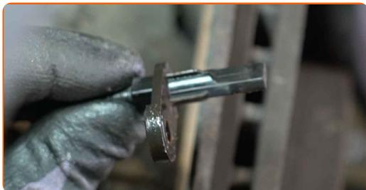
**17** Skru løs festene som binder drivaksel til hjulnavet. Bruk 12-kant-pipe nummer 30. Bruk en skrallenøkkel.
