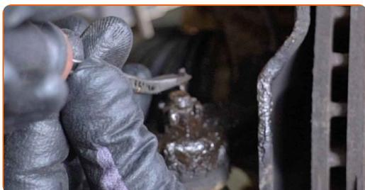
**11** Skru endefestemutteren fast til styrespindelen. Bruk en pipenøkkelinnsats #17. Bruk en skrallenøkkel.
