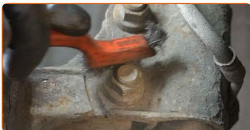
**29** Skru løs festene som kobler fjærbeinet til styrespindelen. Bruk en kombinasjonsnøkkel #19. Bruk en pipenøkkelinnsats #19. Bruk en skrallenøkkel.
