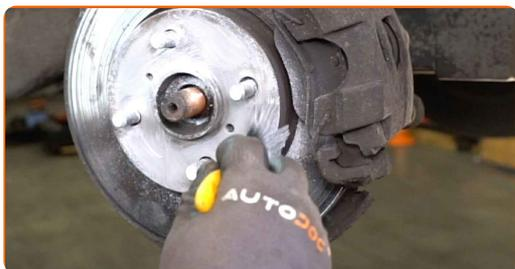
**75** Rengjør overflaten av bremseskiven. Bruk bremsrens.
