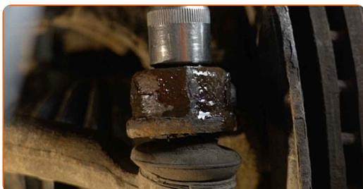
**12** Koble strekkstangenden fra styrespindelen. Bruk en avtrekker for kuleledd.
