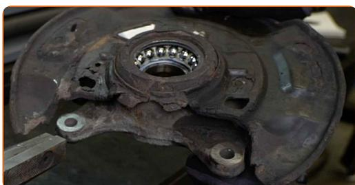
**38** Rengjør låseringen til hjulnavlageret. Bruk en stålbørste. Bruk WD-40 spray.
