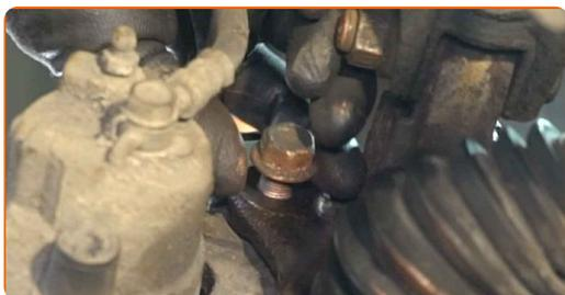
**72** Stram festene til braketten til bremsecaliperen. Bruk en pipenøkkelinnsats #17. Bruk en momentnøkkel. Stram den til 107 Nm dreiemoment.
