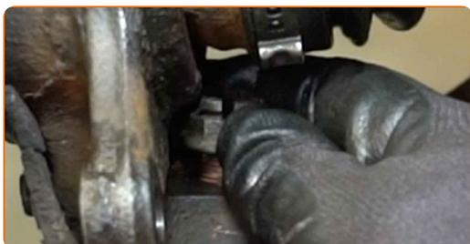
**54** Skru inn festet som forbinder fjærbeinet med styrespindelen. Bruk en kombinasjonsnøkkel #19. Bruk en pipenøkkelinnsats #19. Bruk en skrallenøkkel.
