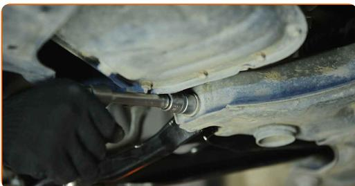
**20** Fjern støtten fra under motoren.
