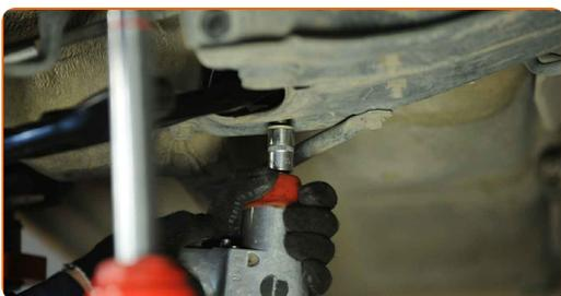
**19** Skru fast festet til den fremre armen. Bruk en pipenøkkelinnsats #17. Bruk en skrallenøkkel. Bruk et svingjern.
