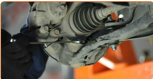
**8** Koble kuleleddet fra styrespindelen. Bruk en avtrekker for kuleledd.
