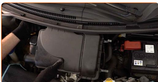
**13** Koble røret til luftinntaket til luftfilterhuset.
