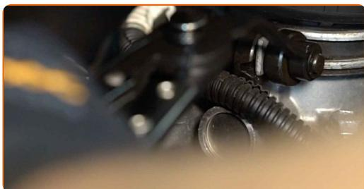
**4** Løs klipsene til luftfilterdekselet.
