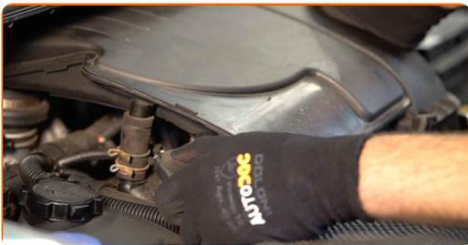
**6** Koble røret til luftinntaket fra luftfilterhuset.
