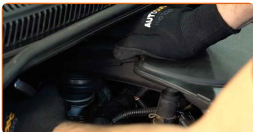
**14** Press klipsene til luftfilterdekselet på plass.
