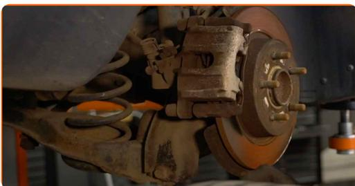
6 Rengjør festene til stabilisatorleddet. Bruk en stålbørste. Bruk WD-40 spray.
