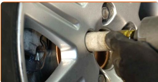
33 Senk bilen og stram hjulboltene, arbeid på kryss. Bruk en momentnøkkel. Stram den til 110 Nm dreiemoment.
