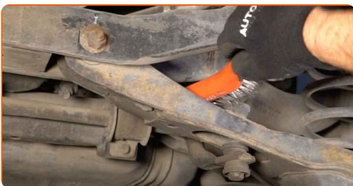
7 Skru løs stabilisatorstang-festene. Bruk en pipenøkkelinnsats #16. Bruk en kombinasjonsnøkkel #15.
