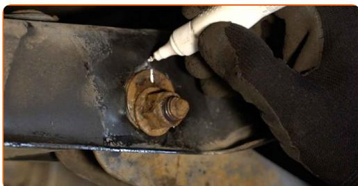
**11** Skru løs festene som kobler bærearman til den bakre underrammen. Bruk en kombinasjonsnøkkel #18. Bruk en kombinasjonsnøkkel #19. Bruk en pipenøkkelinnsats #18. Bruk en skrallenøkkel.
