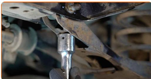
**13** Fjern festebolt. Bruk en spikerdor. Bruk en hammer. Bruk et brekkjern.
