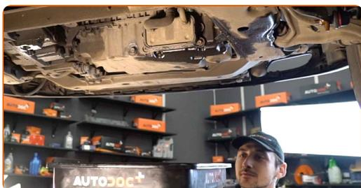
**7** Skru ut bunnpluggen. Bruk en kombinasjonsnøkkel #15. Bruk en pipenøkkelinnsats #15. Bruk en skrallenøkkel.
