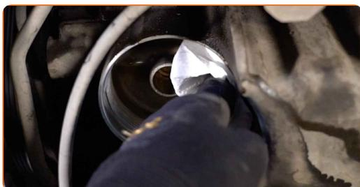
**18** Monter et nytt oljefilter på setet på filterdekslet.
