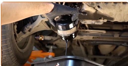
Utskifting: motorolje og oljefilter – Volvo V70 SW. Tips fra AUTODOCs eksperter:
