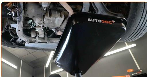
6 Rengjør området rundt dreneringshullet til oljepannen. Bruk en stålbørste. Bruk universal rengjøringsspray.
