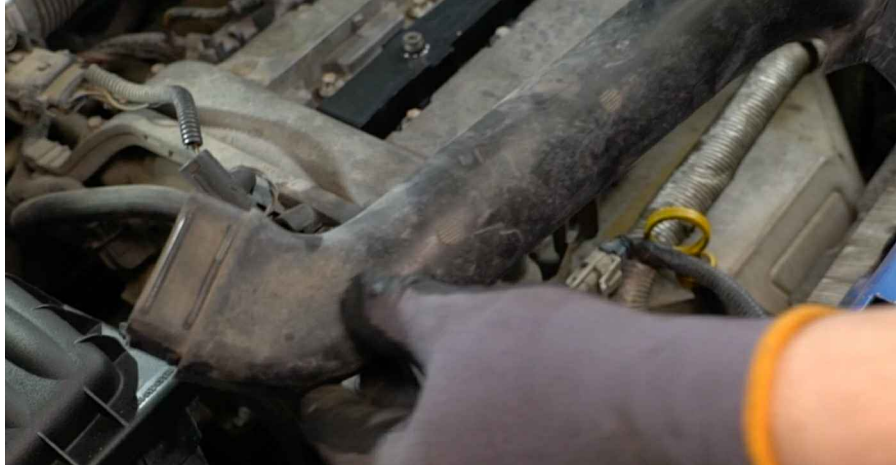
15 Rengjør tilkoblingene til kjølevæskeslangen. Bruk universal rengjøringspray.
