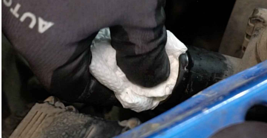
19 Rengjør termostathuset. Bruk en stålberste. Bruk universal rengjøringspray.
