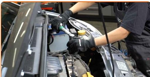
**25** Behandle pluggen til tennspolen med elektrospray. Sprayen beskytter den elektriske kontakten mot korrosjon og oksidasjon, samt reduserer kontaktmotstand.
