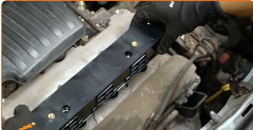
**24** Stram tennspoleboltene. Bruk Torx T30. Bruk en momentnøkkel. Stram den til 7 Nm dreiemoment.
